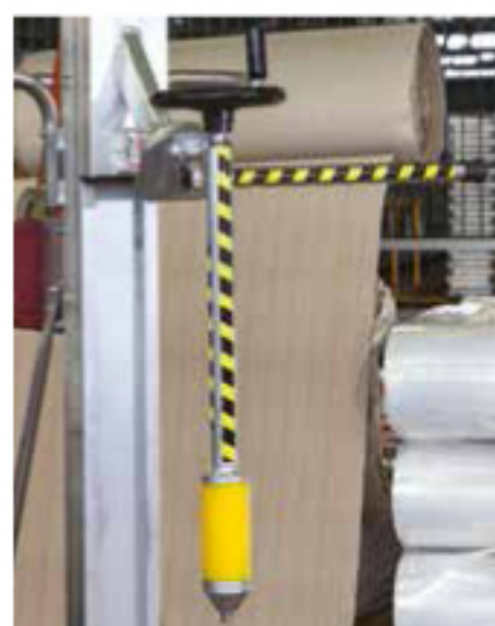
Tirando il gancio si porta l'HW I.MA da posizione 1 a posizione 2. By pulling the hook, the position of HW I.MA switches from 1 to 2.
