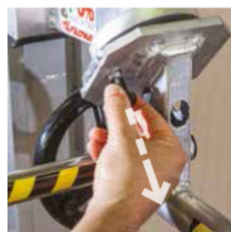
Tirando il gancio si porta l'HW I.MA da posizione 1 a posizione 2. By pulling the hook, the position of HW I.MA switches from 1 to 2.
