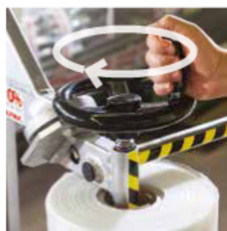
Ruotando la manopola si fissa il rotolo per essere spostato. Turn the knob to position the roll to be moved.
