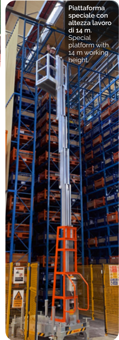
Piattaforma Elevah speciale con sistema di blocco ruote e pedali di guida sul cestello. Special Elevah platform with wheel locking system and guide pedals on the basket.
