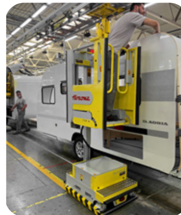
Piattaforma Elevah speciale con sistema di blocco ruote e pedali di guida sul cestello. Special Elevah platform with wheel locking system and guide pedals on the basket.
