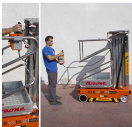
CA Télécommande supplémentaire pour le chargement sur les rampes
