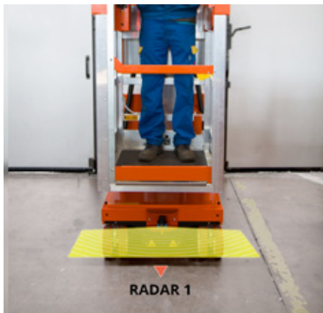
RADAR1 Système anticollision radar frontal.
