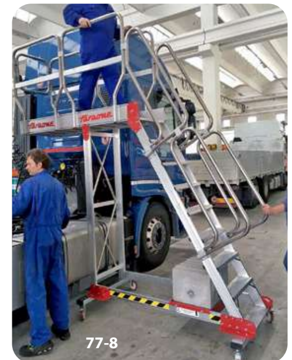
Scala speciale a sbalzo frontale con ruote pneumatiche. Special ladder with frontal landing and pneumatic wheels
