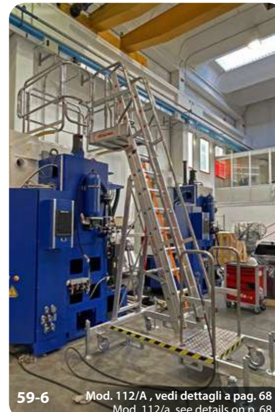
Scala System a sbalzo frontale con passerella richiudibile e parapetti telescopici. Scala System with frontal landing, foldable walkway and telescopic guardrails.
