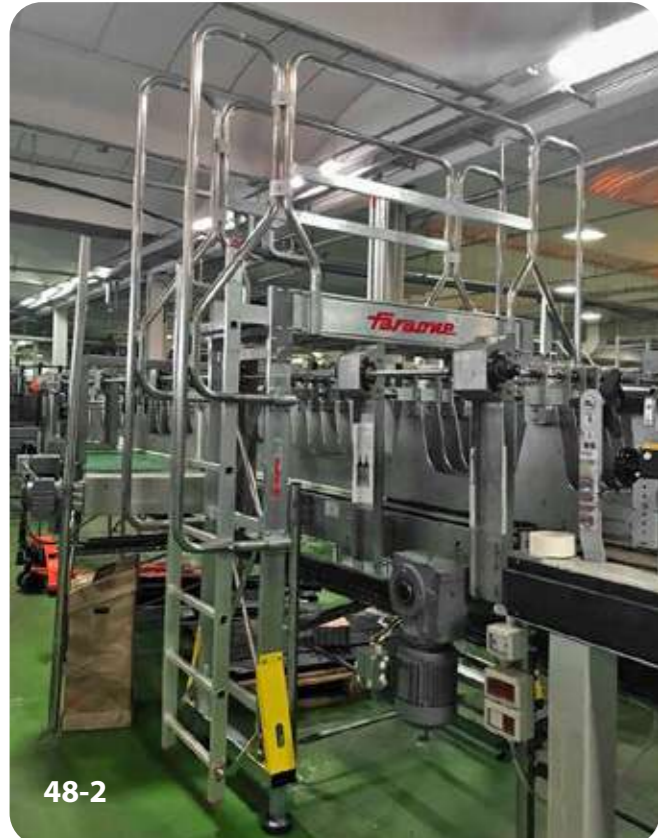
Scala a ponte ad L con doppia salita. L-shaped dual-access ladder.
