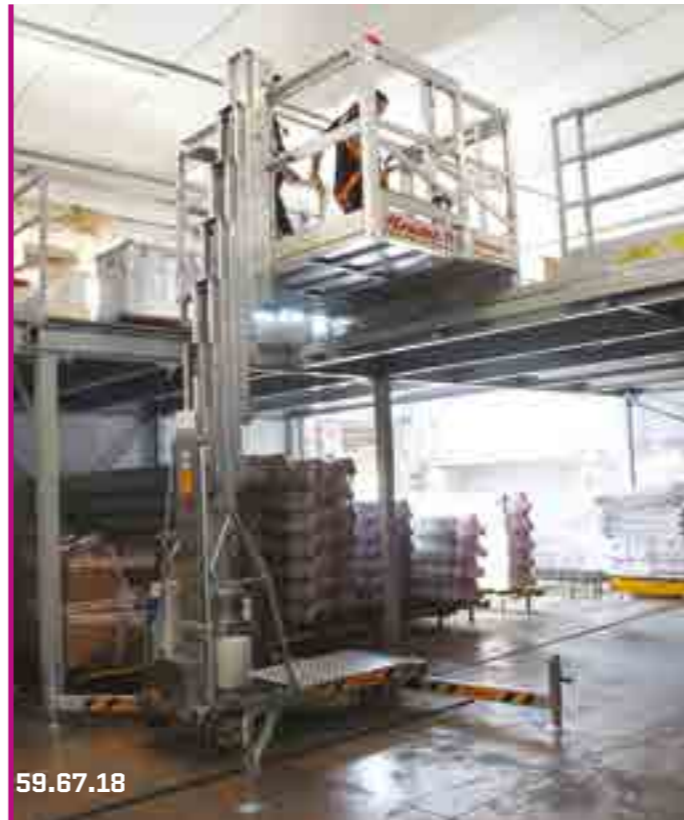
Plattform zum Ausladen in der Höhe, für 2 Mitarbeiter. Vom TÜV zugelassen. Plate-forme pour débarquement en hauteur de 2 opérateurs. Homologation par l'organisme TÜV.
