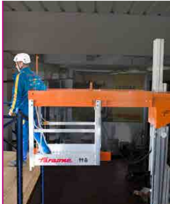
Plattform Elevah zum Ausladen in der Höhe, für 1 Mitarbeiter. Plateforme Elevah pour le débarquement en hauteur d'1 opérateur.
