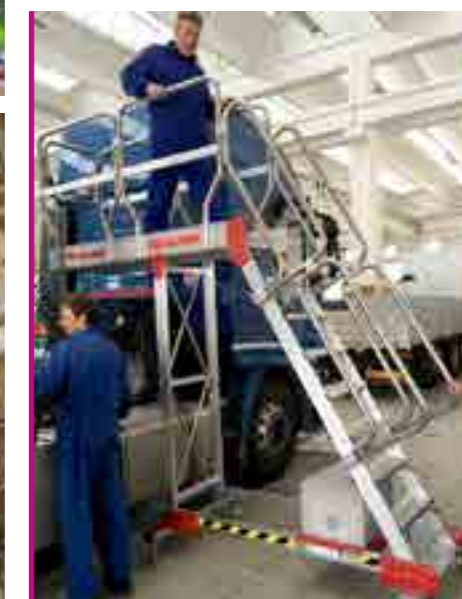
Leiter mit Überhang für die Wartung von Schleppern Échelle en porte-à-faux pour la maintenance des motrices
