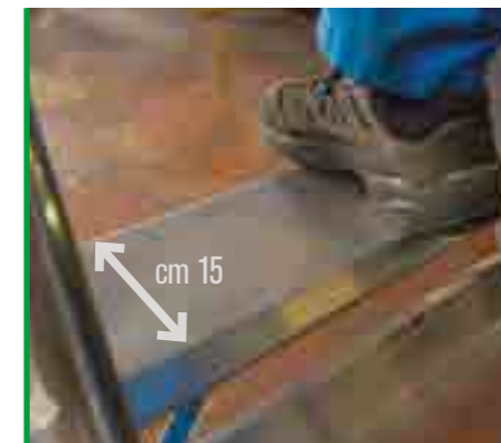
15-cm-Stufen zum sicheren Hochsteigen. Marche de 15 cm pour une montée en toute sécurité.
