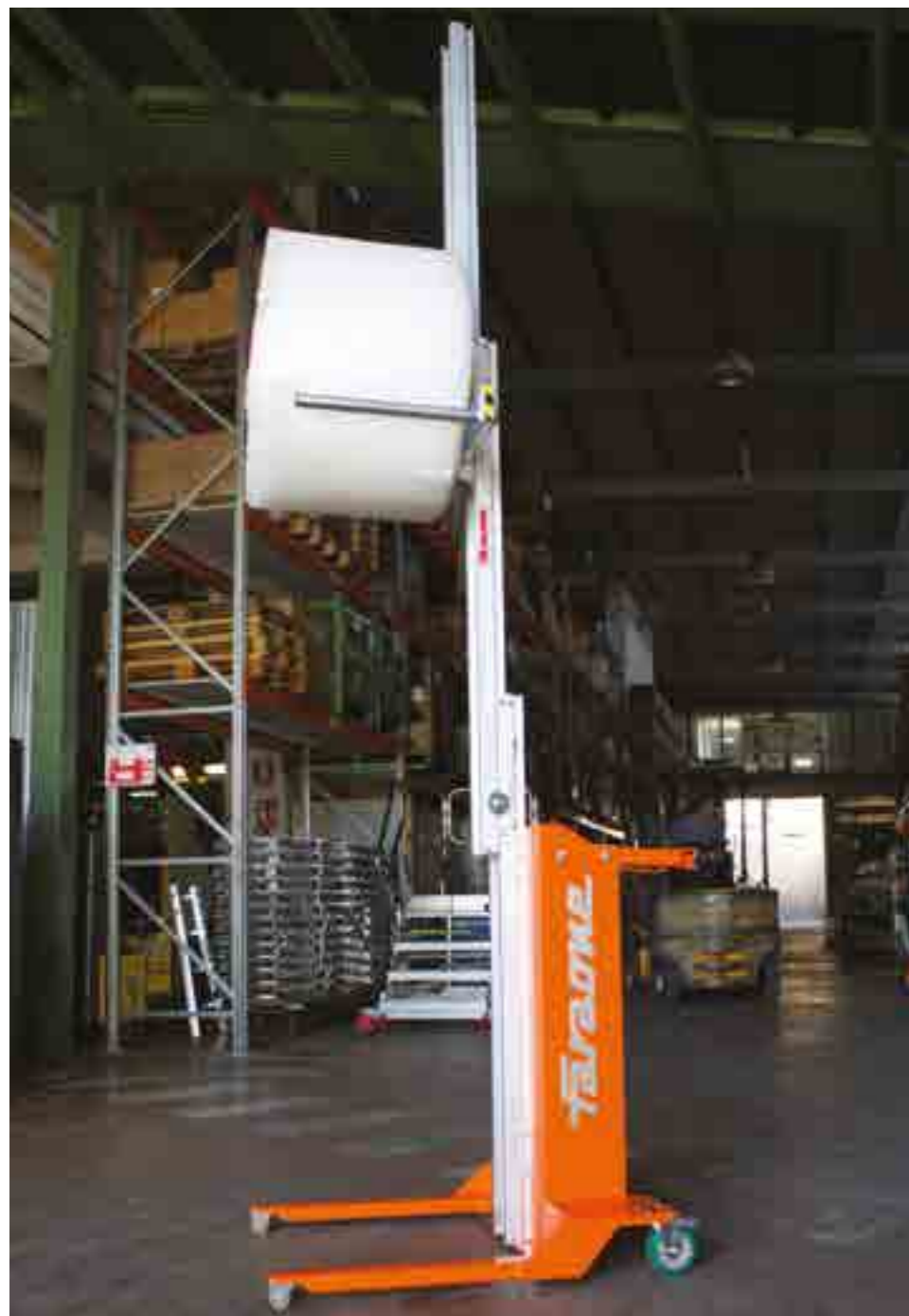
Base basse spéciale pour un accès facile / palette. Special low base for easy access/pallets.
