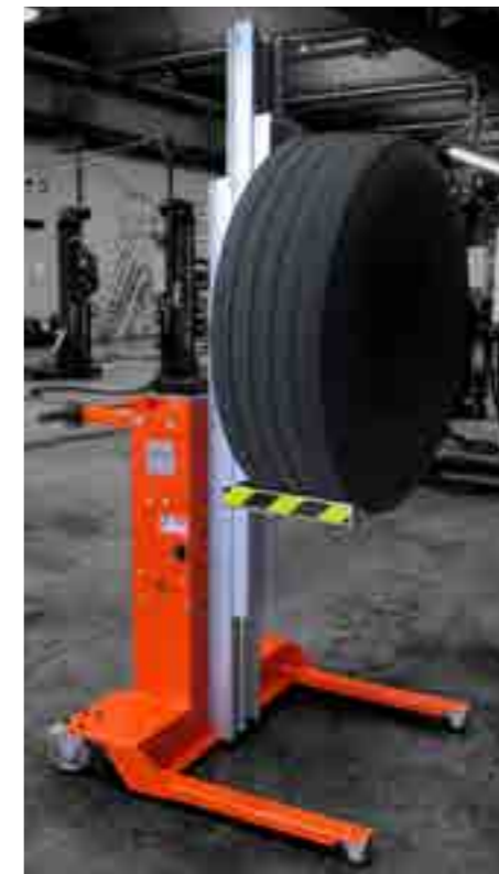
HW.I BIG mit HW.RU, einstellbare Gabeln zur Entnahme von Reifen. HW.I BIG avec HW.RU, fourches réglables pour l'enlèvement de pneus.
