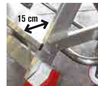
15-cm-Stufen zum sicheren Hochsteigen. Marche de 15 cm pour garantir une montée en toute sécurité.
