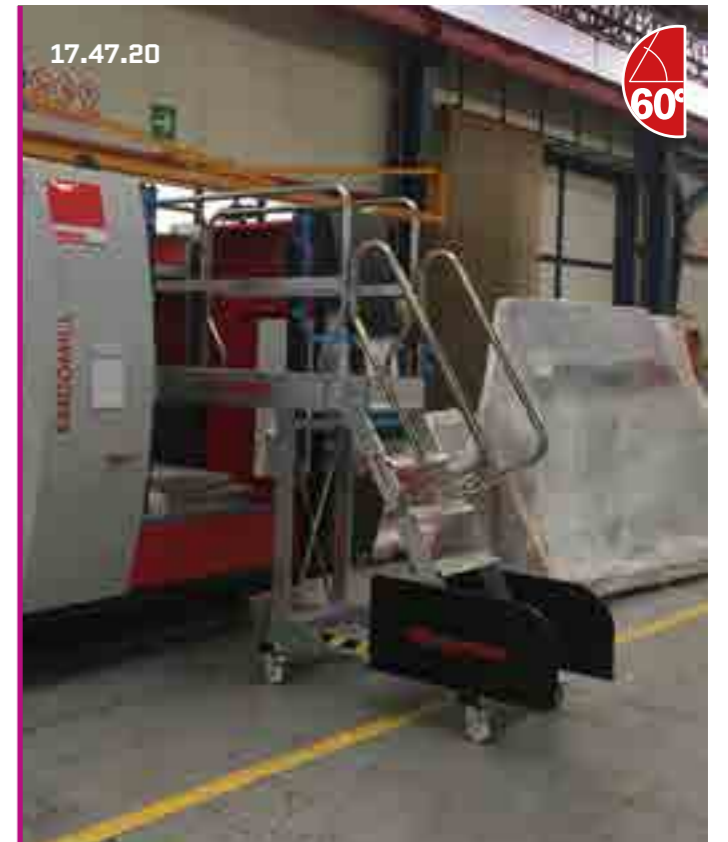
Leiter mit frontseitigem Überhang und kompaktem Gestell. Échelle en porte-à-faux frontal avec base compacte.
