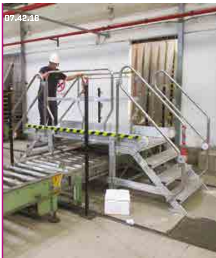
Treppe mit einziehbarem Überstieg zum Überschreiten der Produktionslinie. Échelle pont escamotable pour traverser les lignes de production.
