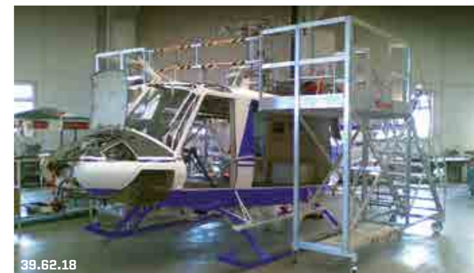
Leiter mit Überhang für die Wartung von Schleppern Échelle en porte-à-faux pour la maintenance des motrices
