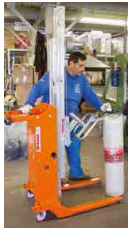
HW.I BIG mit HW.HW.2, Arm mit Rohrarretiersystem und Drehmöglichkeit, zur Entnahme von Rollen. HW.I BIG avec HW.HW.2, bras doté d'un système de blocage du tube et rotation pour l'enlèvement de bobines.
