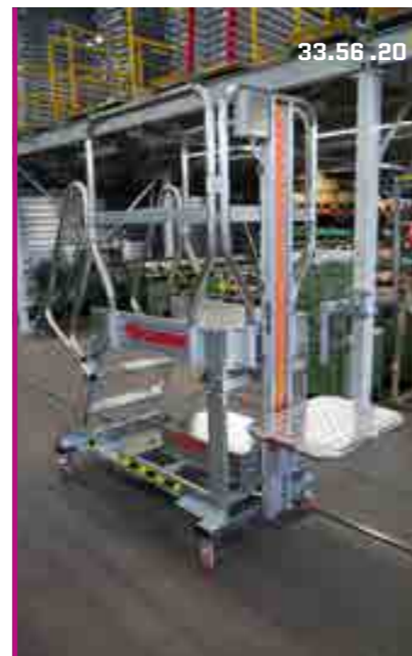
Rolleiter mit elektrischer Picking-Plattform. Escalier de rayonnage avec plan de picking électrique.
