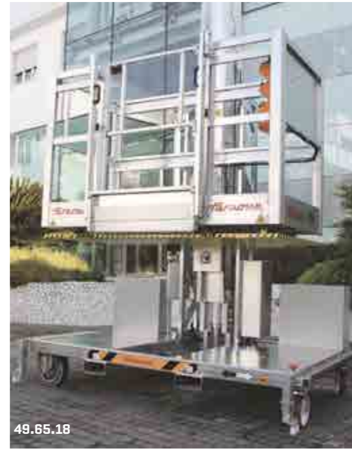
Hubstapler für die Lagerung von Reifen. Chariot élévateur pour le stockage des pneus.
